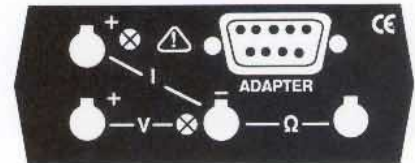
Bodenplatte des CIT mit DC/NF-Anschlüssen
